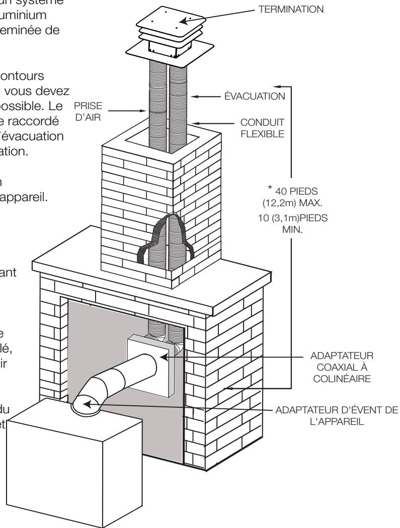
\* Mesurée à partir de la buse de l'appareil jusqu'au collet de la terminaison.
