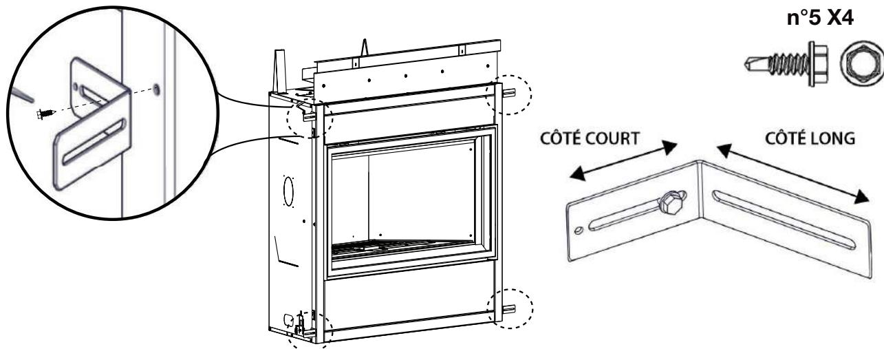
Utiliser une vis autotaraudeuse pour fixer la côté court du support de fixation à l'appareil. Répétez pour les 3 autres locations.
