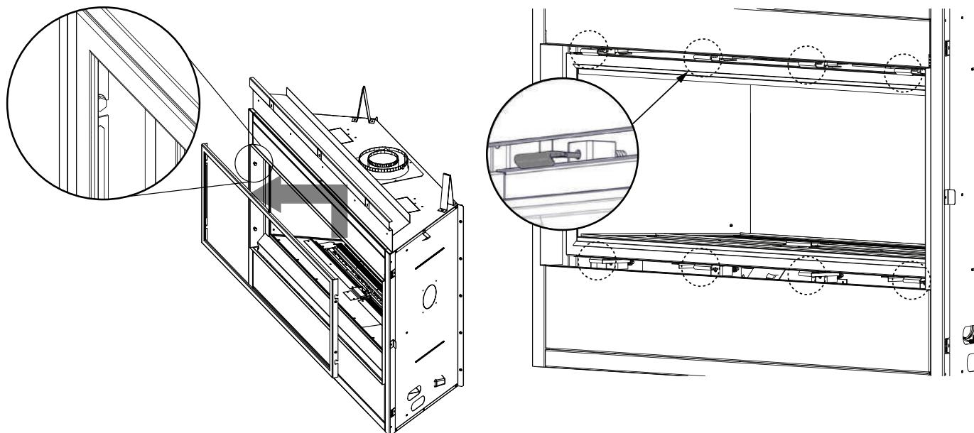
Avant d'enlever la porte vitrée, l'écran de protection doit être enlever. Soulevez l'écran de protection hors des 4 goupilles et enlever de l'appareil.
